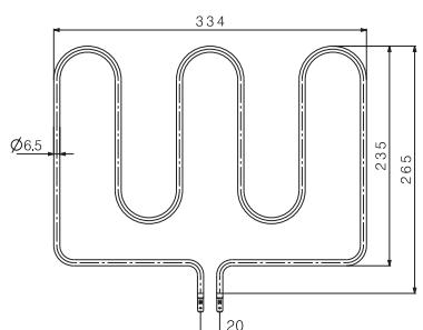
**Grejač peći za oblane / Heater for waffle**
